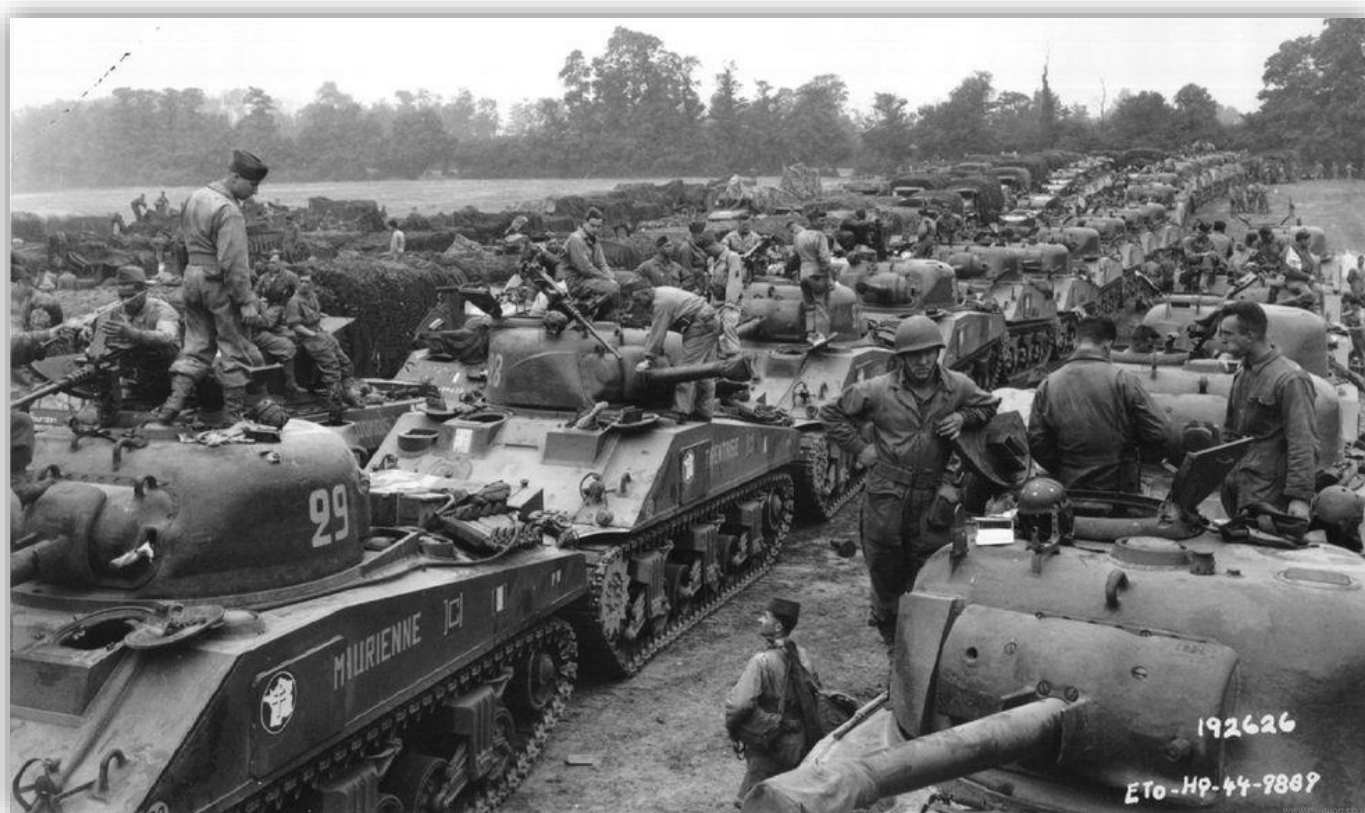
Den amerikanska M-4 Sherman stridsvagnen var dåligt rustad för att utmana tyska tanks. Författaren och veteranen Belton Cooper skrev en uppmärksam bok med titeln "Death Traps" som handlar om hur hopplöst underlägsna Sherman-besättningarna var i direkt strid mot tyska tanks. Men bristerna komparerades med högt antal. Här ser vi franska styrkor, utrustade med Shermans.
