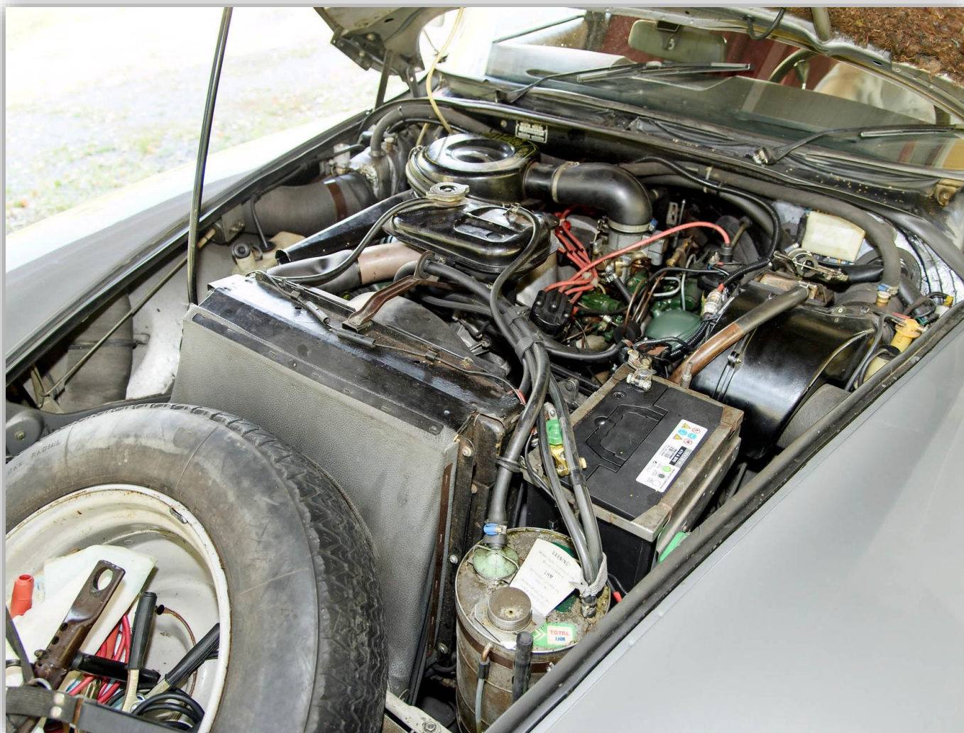
En av bilvärldens längsta motorhuvardöljer ett hav av hydraulikslangar och en gammal stötstångsfyra med rötter i 1930-talet. Stora DS 23-motorn kom 1972.
