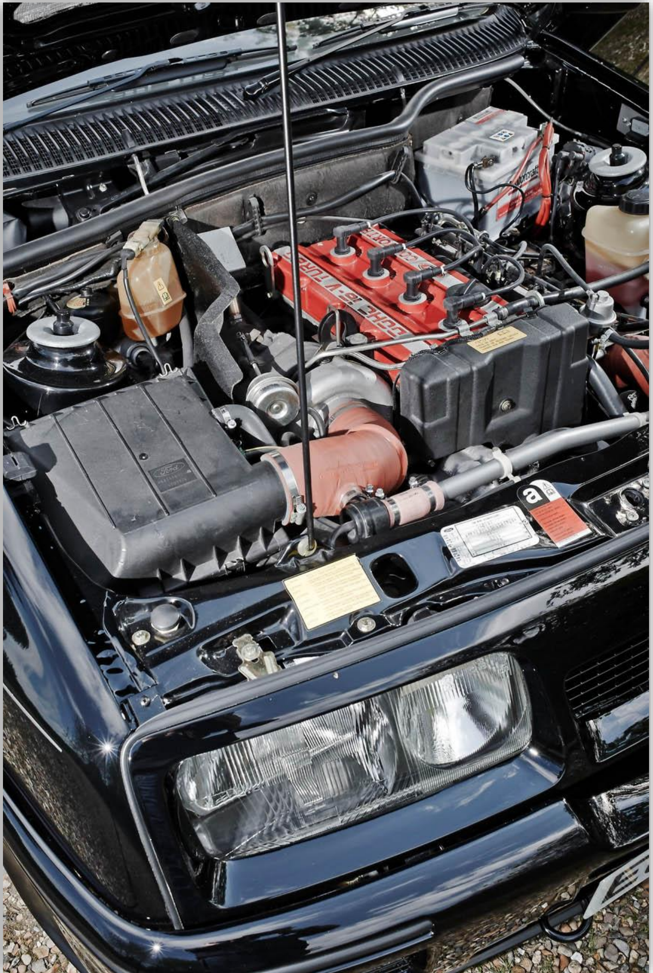
Cosworths YBB-motor gav Ford den kraftkälla som behövdes för att vinna de stora racingloppen. Som mest runt 680 hästar i Australien när det begav sig.
