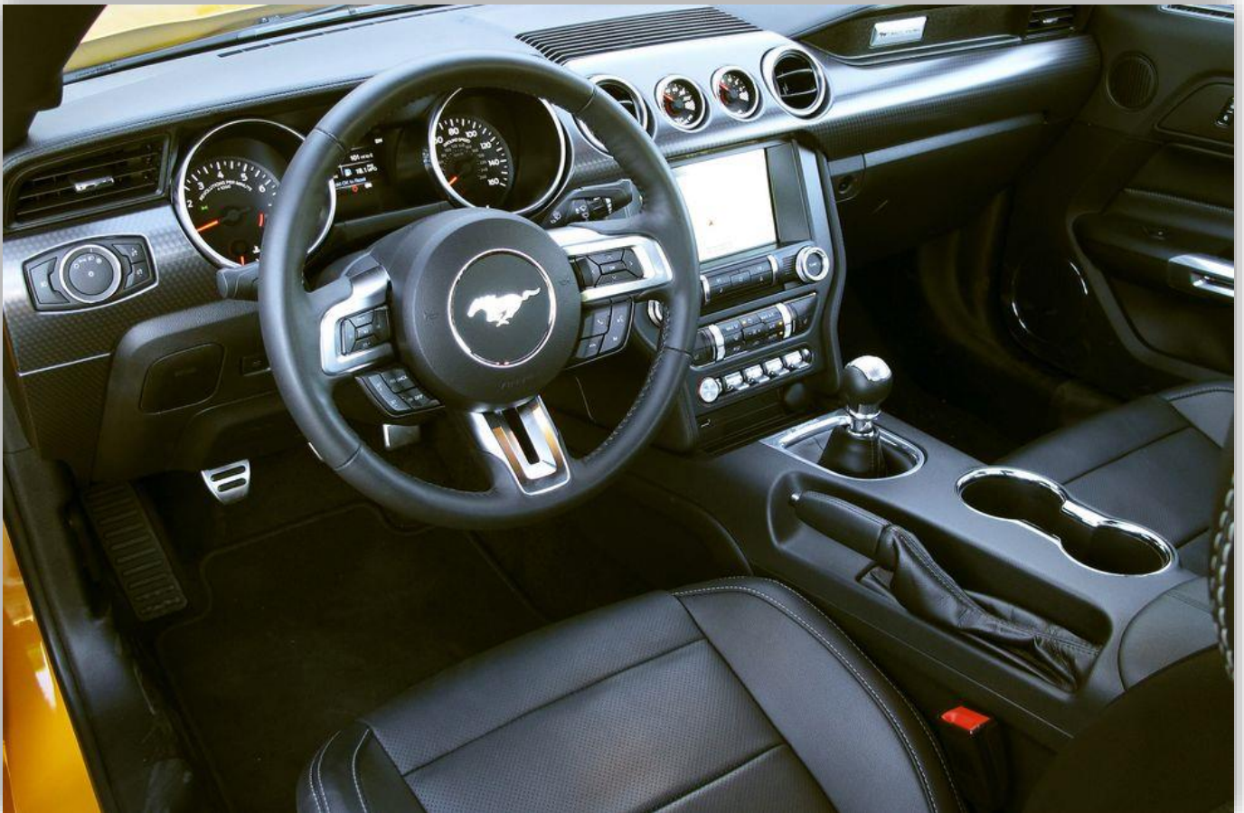
De två mätarna ovanför skärmen visar oljetryck och vakuum. Del av Performance Package i USA.
