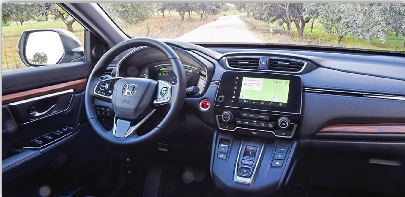
Knappstyrd växelväljare. Rattpaddlarna styr bromsregenereringen.
