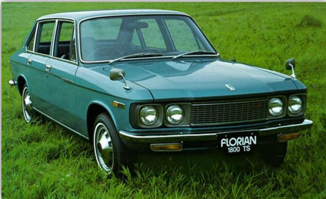
Första åren hade den rektangulära lyktor, efter 1971 fick alla dubbla lampor som på TS.
