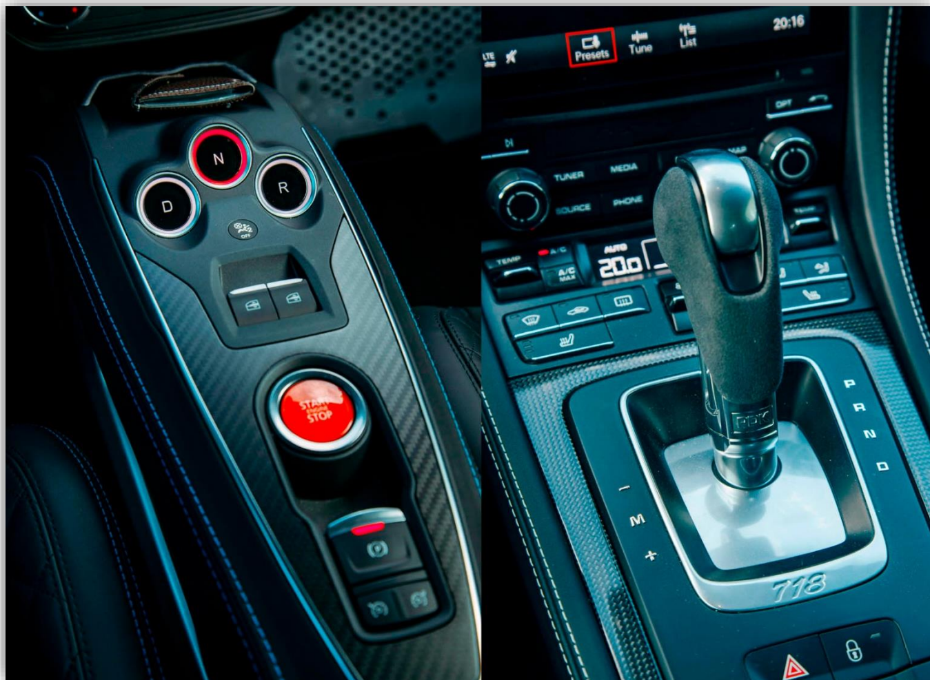
Många knappar i Alpine känns igen från Renault. Växlarna väljs med tryckknappar på mittkonsolen. Dubbelkopplingslådan med sju växlar gör Porschen hela 33 900 kronor dyrare.
