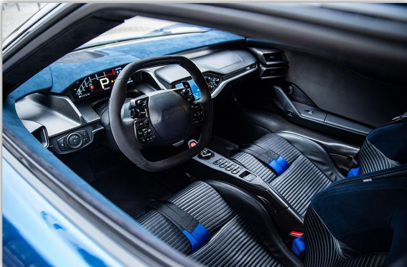
Instrumentpanel i kolfiber och en bärande del av konstruktionen. Ljusomkopplaren till vänster om ratten är från Focus, så även växelväljaren.
