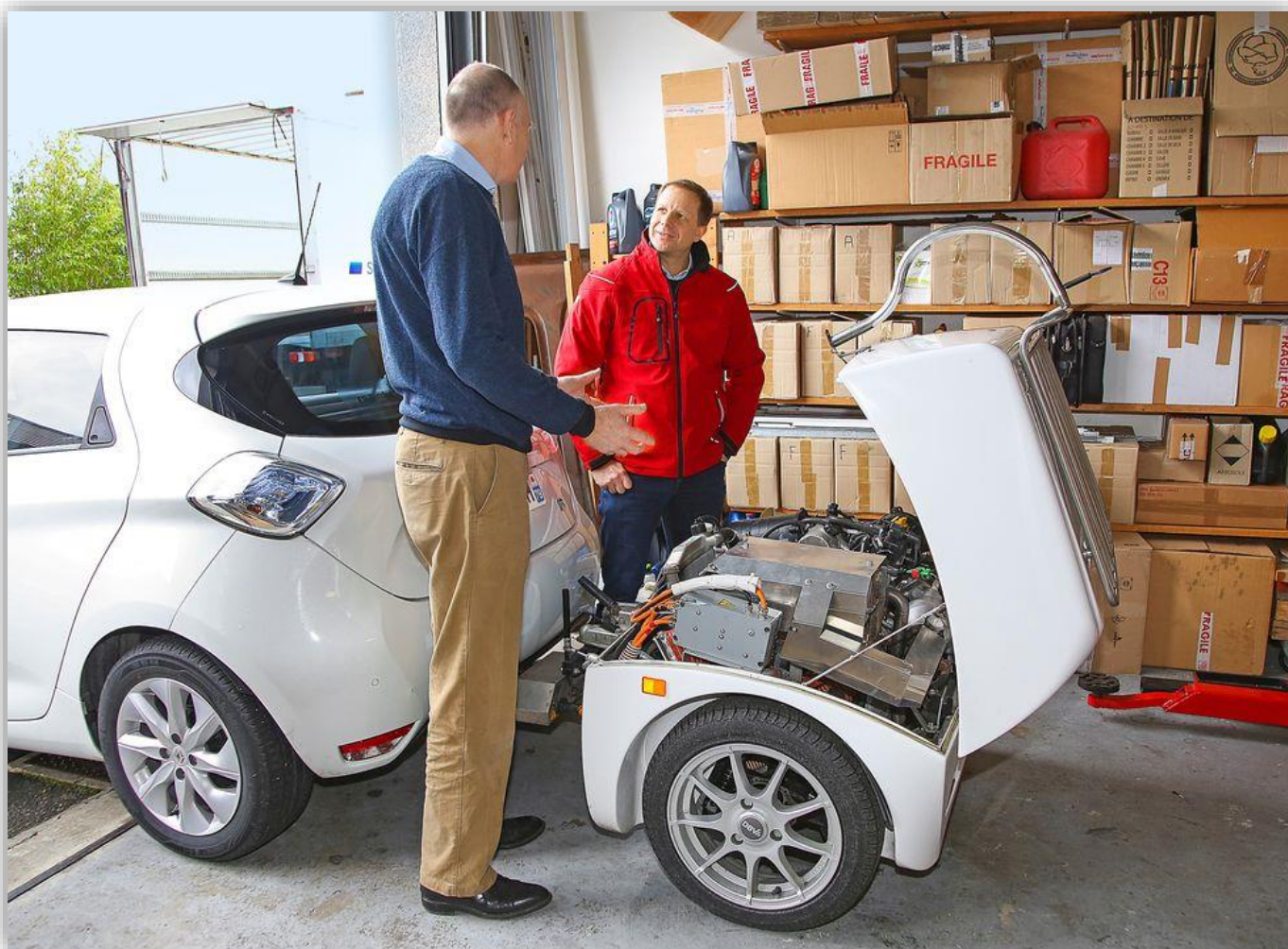
Under släpkärrans kåpa sitter en tvåcylindrig bensinmotor från Tata på 38 hk.
