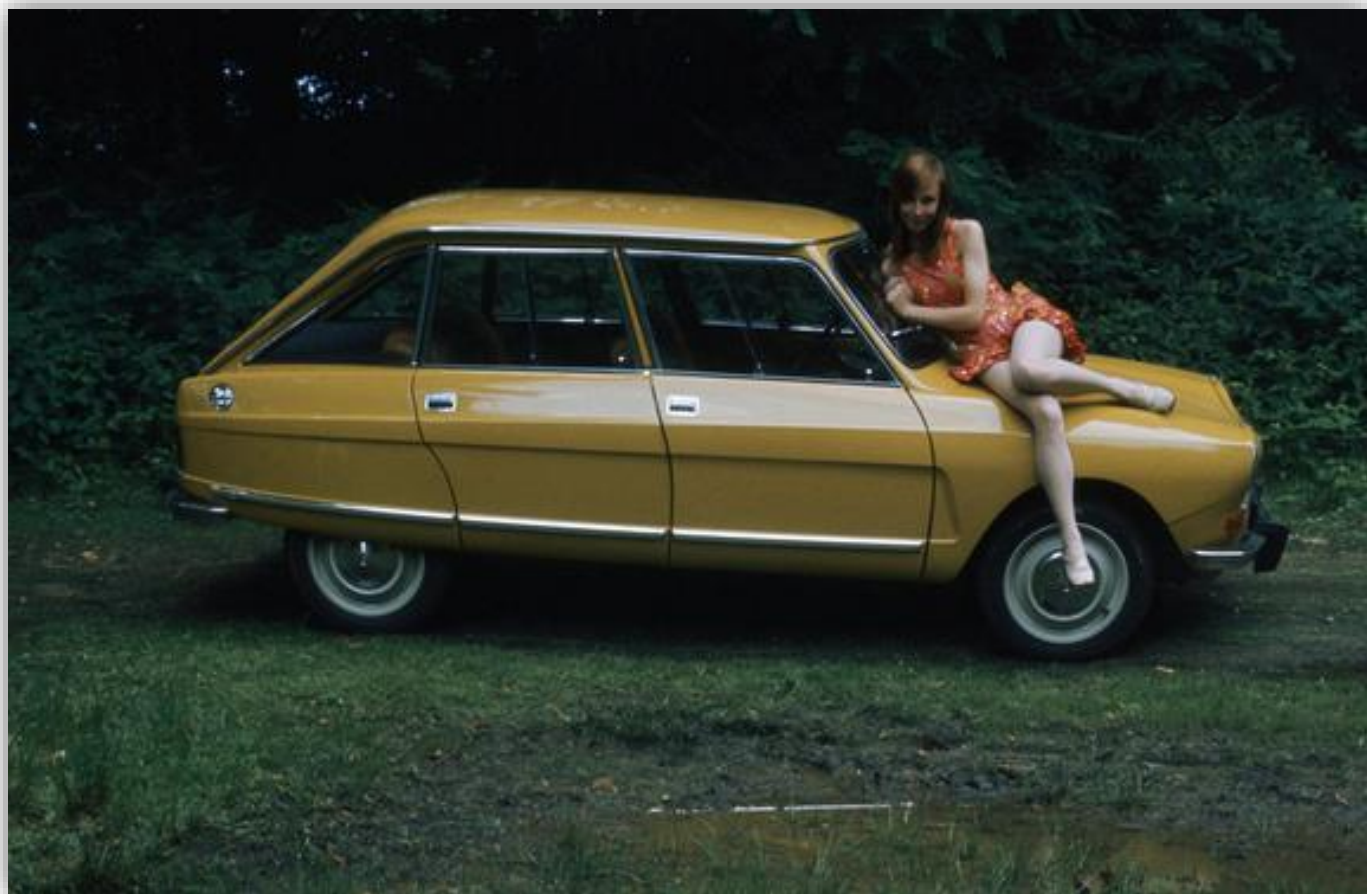
Efterträdaren hette Ami 8, i Sverige mi 8, och kom 1969 då Ami 6 fasades ut. Den nya bilen hade ett utsläpat nosparti och fick fastback i stället för den inverterade bakrutan. Motorn gav nu 35 hk.
