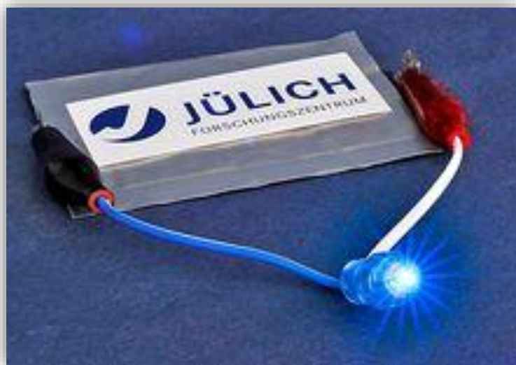
Battericeller av solid state-typ är mycket kompakta och energitäta, men hittills bara i labbet.
