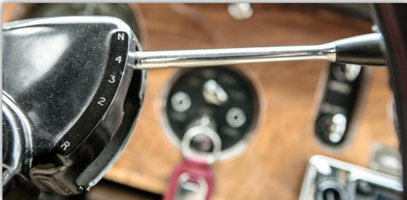
Växellådan har fyra växlar framåt och en bakåt. Fullt tillräckligt för den urstarka V8:an att spela med.
