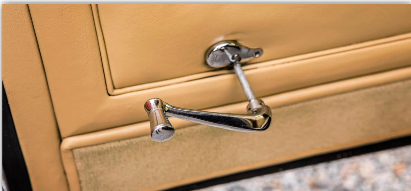
Silver Cloud har eldrivna fönsterhissar. Dessa eleganta vevar används endast om elektroniken felar.
