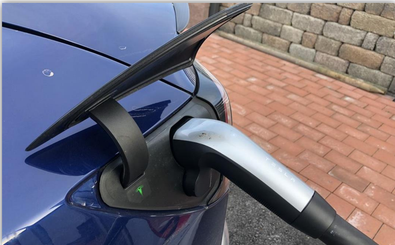
CCS-laddning matar på i upp till 120 kW. Jag fick som mest 118 kW.
