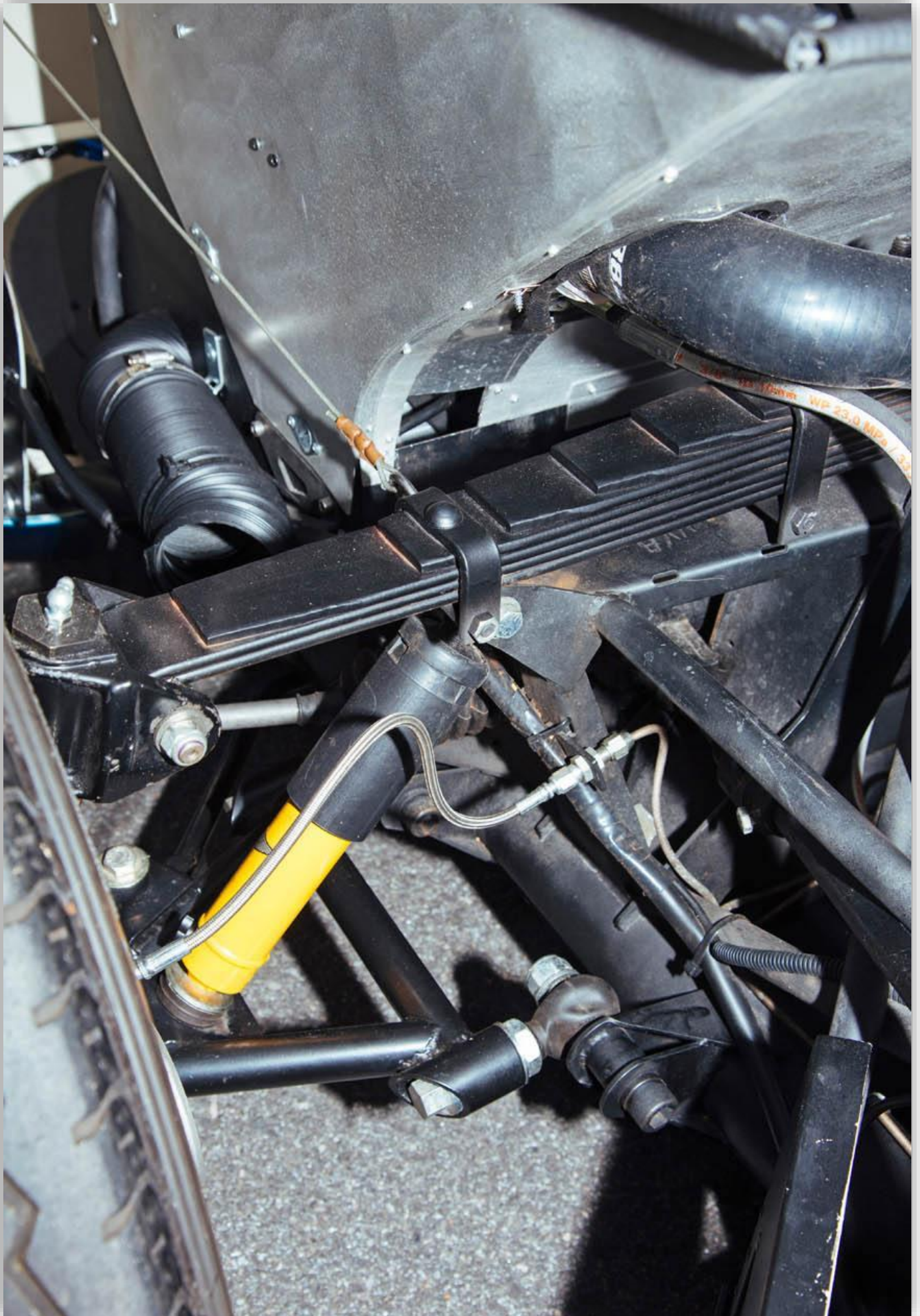
Konstruktionen med tvärrättade bladfjädrar både fram och bak var så långt ifrån hi-tech man kunde komma även 1964.
