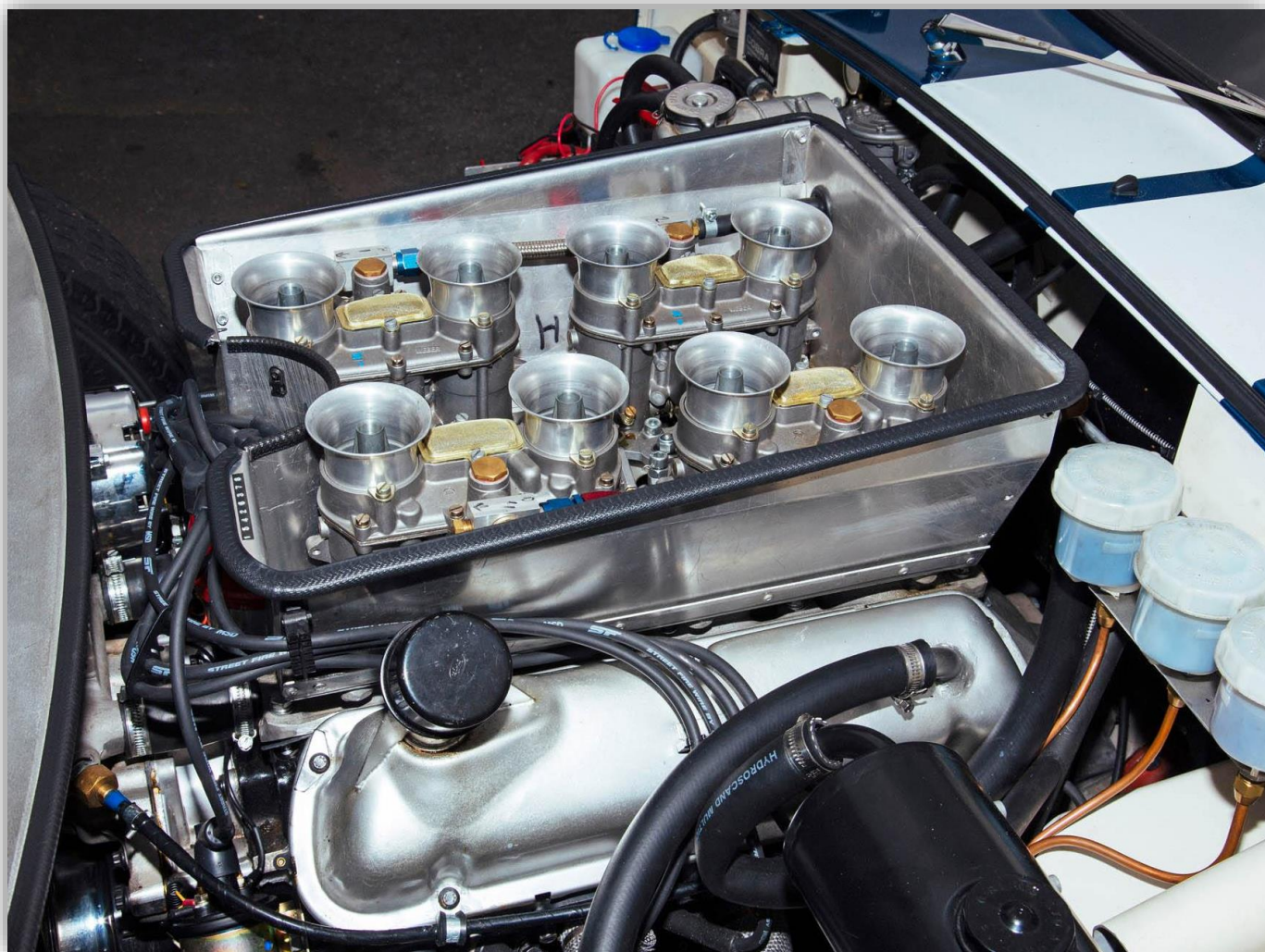
V8-motorn på 4,7 liter är byggd exakt så som FIA-reglerna för Shelby Daytona Cobra föreskriver, vilket resulterat i 348 hästar på drivhjulen.
