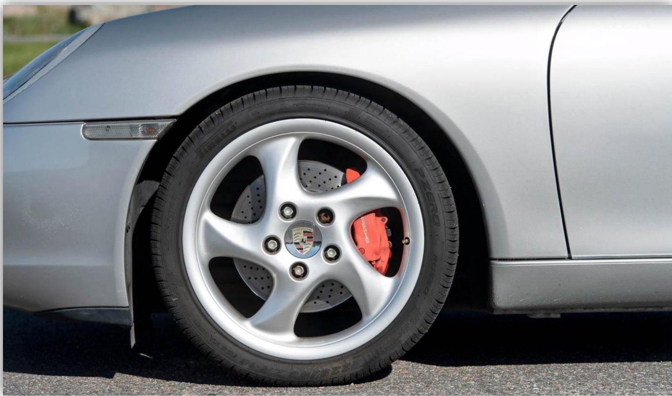
Röda bromsok och perforerade skivor skiljer Boxster S från Boxster "utan S".
