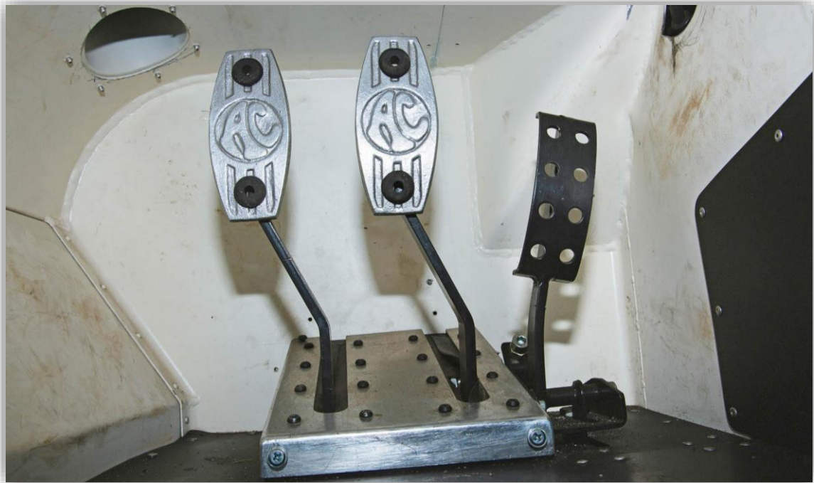
Stående pedaler! Fotutrymmet blev varmare än en bastu, därför fixade teamet snart luftintag – syns högst upp till vänster.
