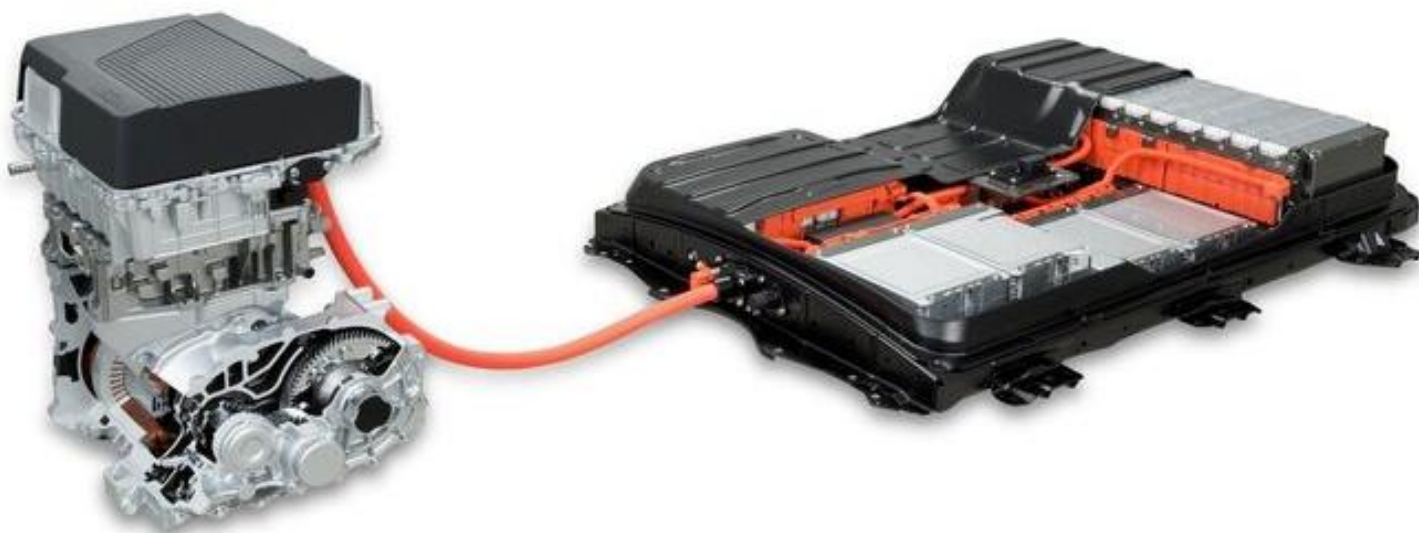
Elmotorn och batteriet till Leaf.
