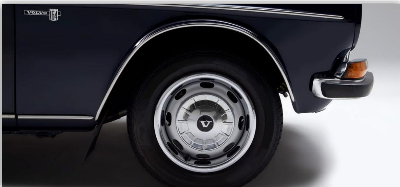
Hjulen hade plåtfälgar, var 5,5 tum breda med däck av typen 165 SR 15.
