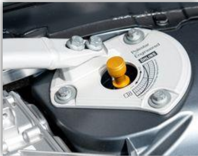
Öhlinsdämparnas hårdhet justeras för hand. Från fabrik har de en mellanhård inställning.
