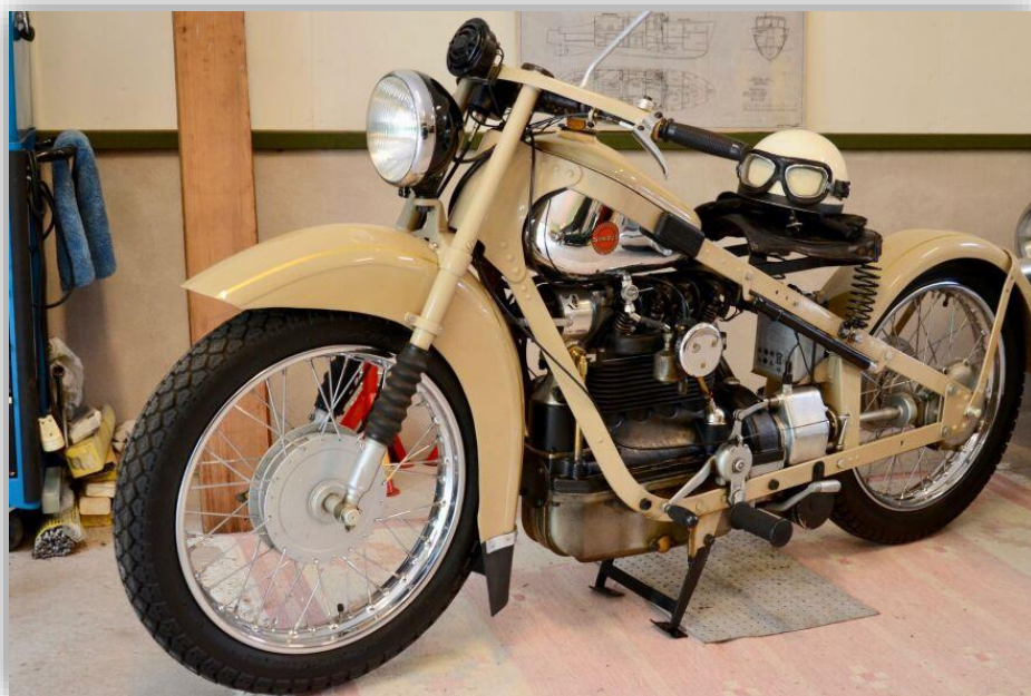
Nimbus 1939 med fyr cylindrig motor och kardandrift.
