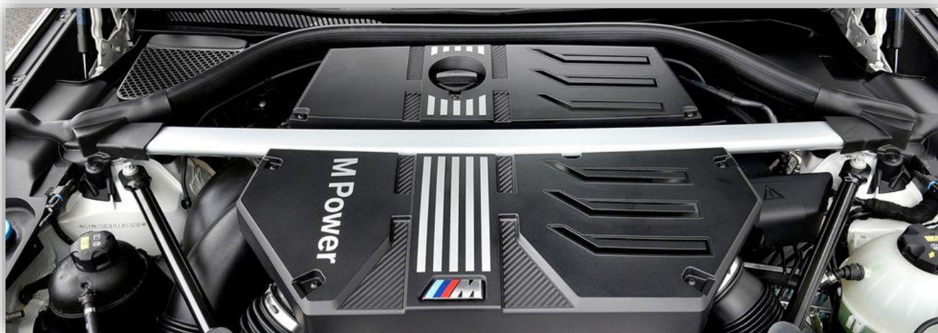
Ett mäktigt tvärstag mellan fjäderbenen håller framvagnen i schack.
