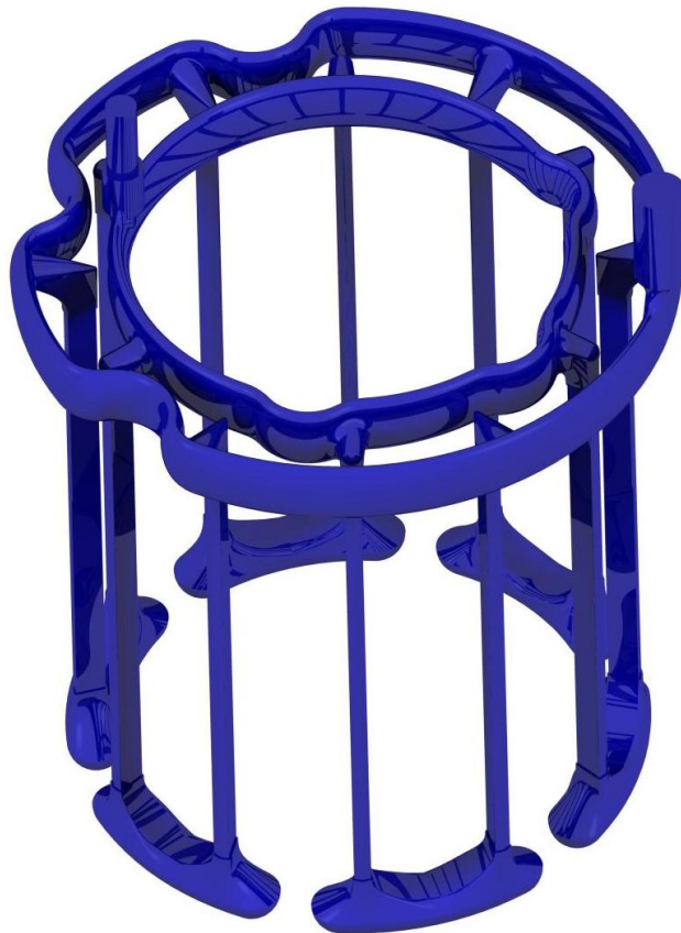
Kylkanalerna som blir inbyggda i den nya motorkonstruktionen
