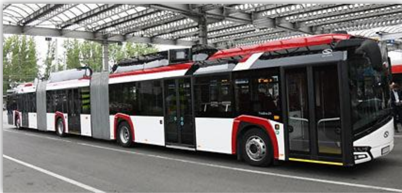
Solaris samarbetar med PKT Gdynia om homologiseringen av sin nya, 24-meters trådbuss som också kommer att finnas som batteribuss.
