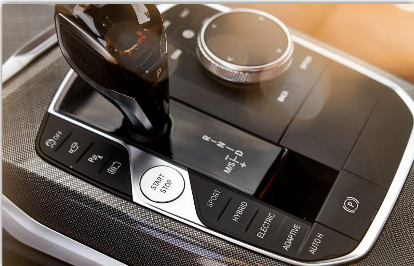
Körläge väljer man med knapparna vid växelväljaren. Hybrid är grundläget som bilen startar i även med fulladdat batteri.
