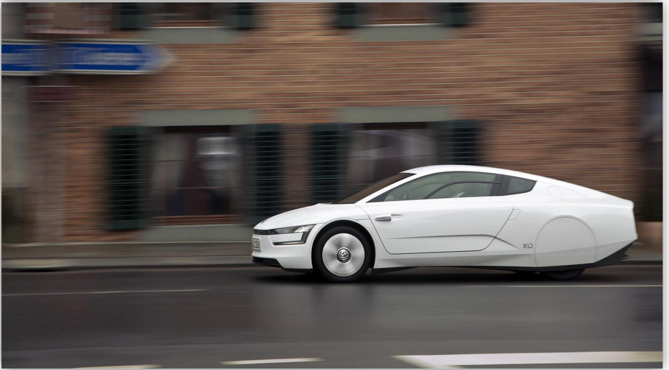
Volkswagen XL1 är hal med en luftmotståndskoefficient på 0,189. Prototypen av XL1 hade ännu lägre värde på 0,186.
