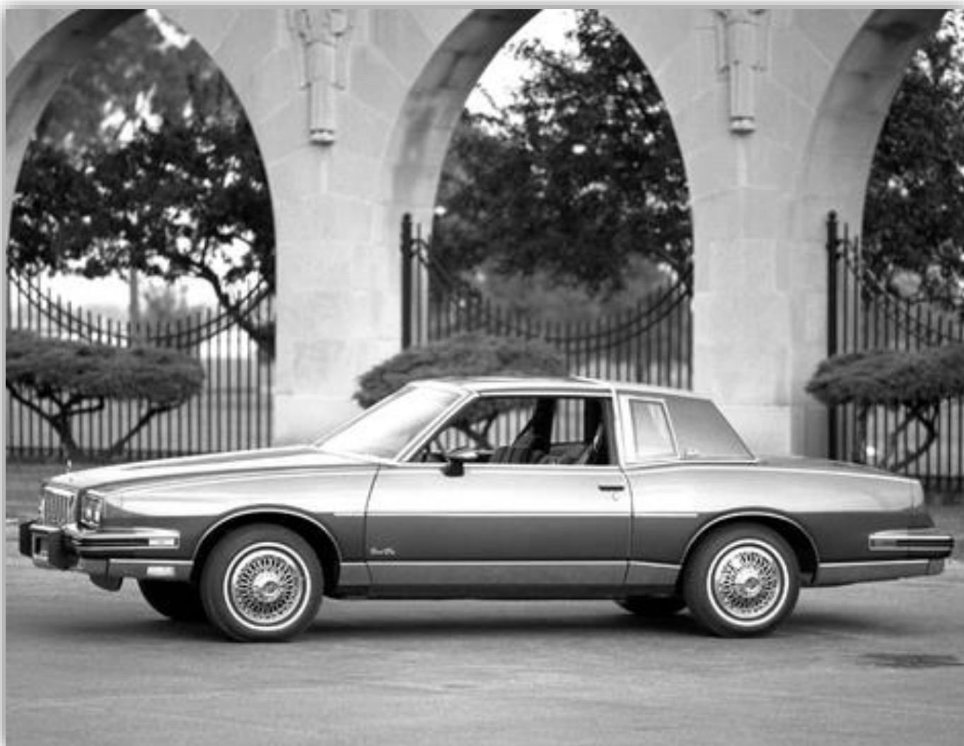
1985 års Grand Prix. En lite mindre storlek som kom redan 1978. Inom de egna leden byggdes en mängd bilar på samma bas. Buick Regal, Chevrolet Malibu, Chevrolet Monte Carlo, Oldsmobile Cutlass Supreme, Pontiac Bonneville och Pontiac Lemans. Största V8 var på 350 kubiktum.
