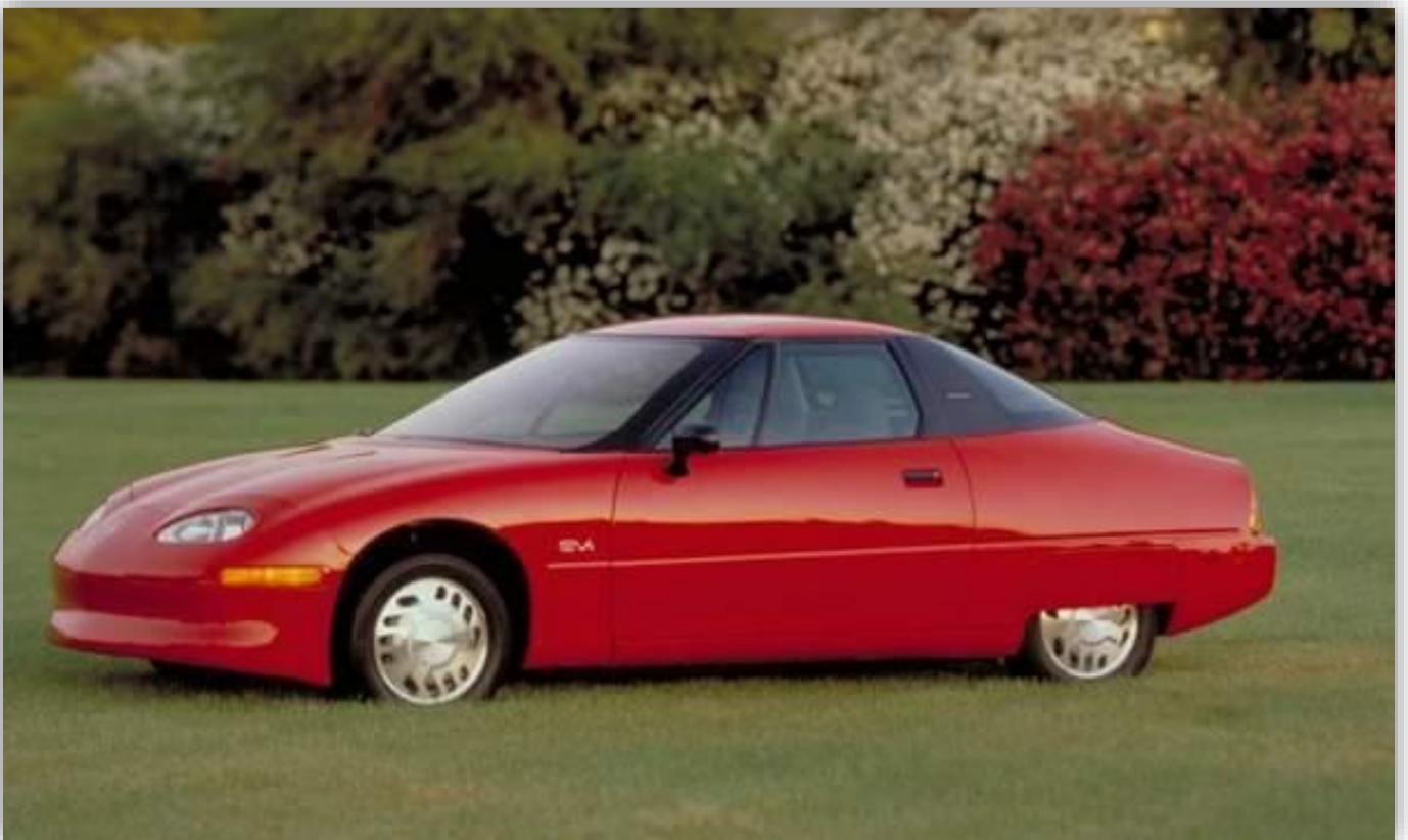
General Motors EV1 är även den hal med en luftmotståndskoefficient på 0,19.
