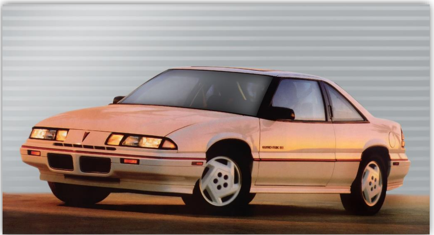
1988-96 Grand Prix kallas generation 5. Framhjulsdrivna bilar med antingen en rak fyra eller olika V6 versioner att välja mellan, med turbo gav värsta V6;an 210 hk.
