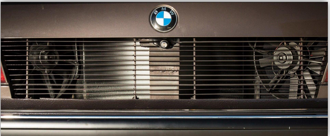
Den märkliga svulsten, det finns likadan på vänster bakskärm, leder in luft till bagageutrymmet....
