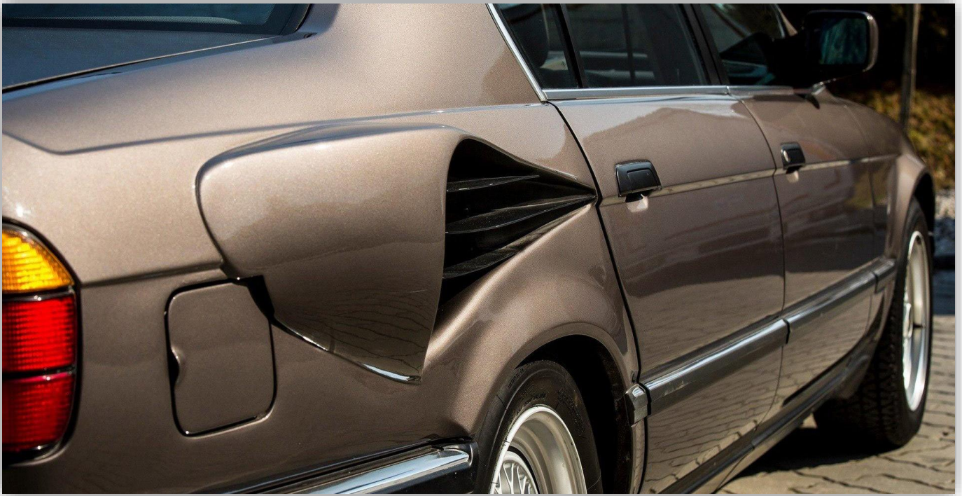
Den märkliga svulsten, det finns likadan på vänster bakskärm, leder in luft till bagageutrymmet....
