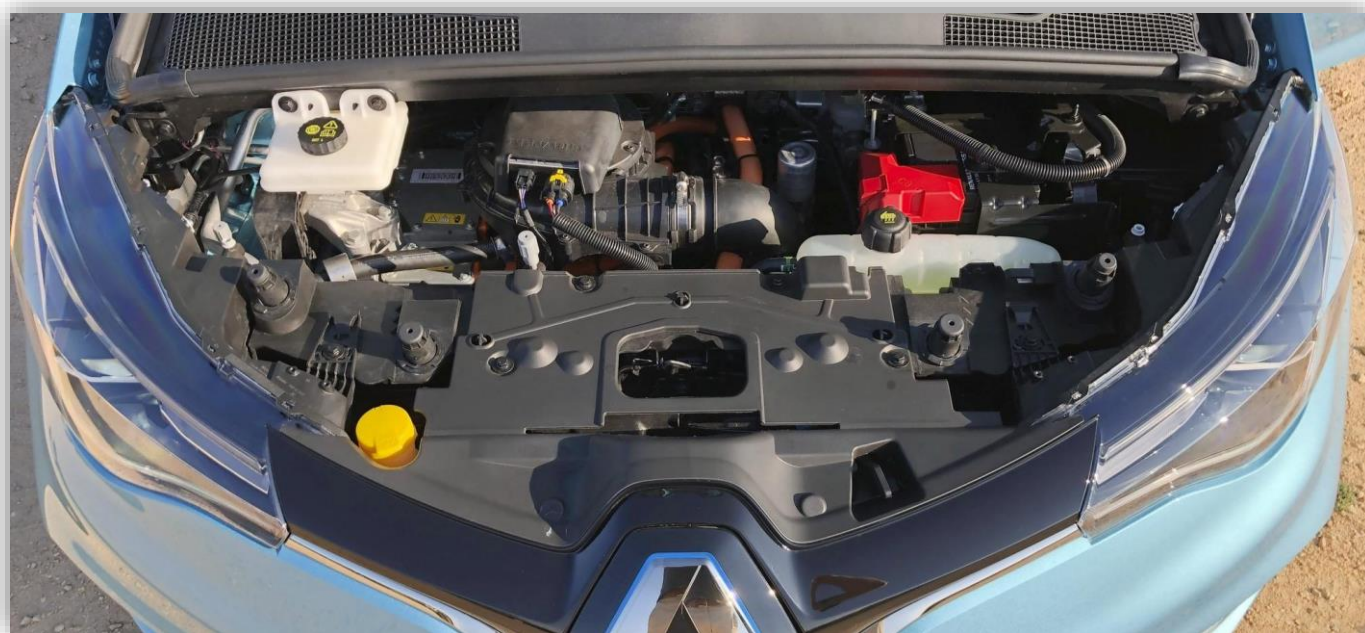
All elektronik, bortsett från batteripaketet, sitter under motorhuven fram.
