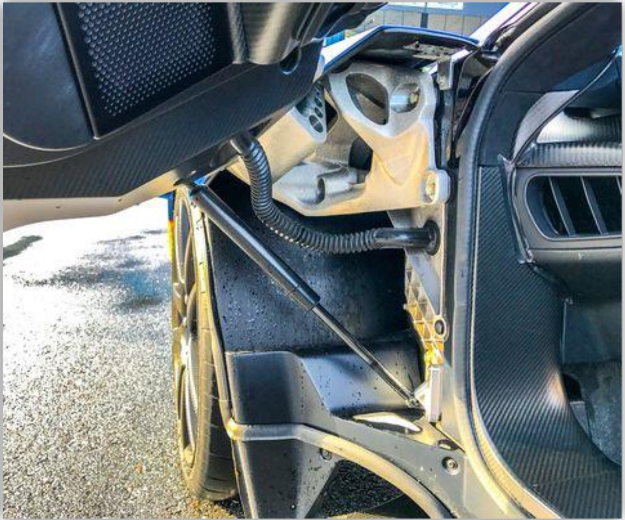
När man öppnar dörrarna blottar man mycket naken kolfiber, notera här både tröskel och instrumentbräda. Längst in tuffa gångjärn i aluminium.
