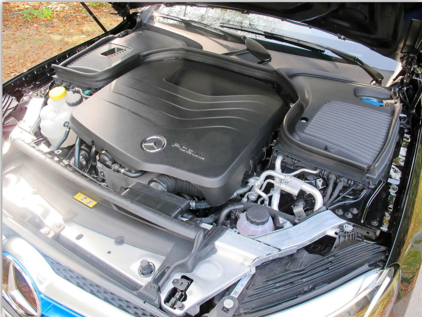
Bränslestacken ryms numer under huven. Batterier finns under golvet.
