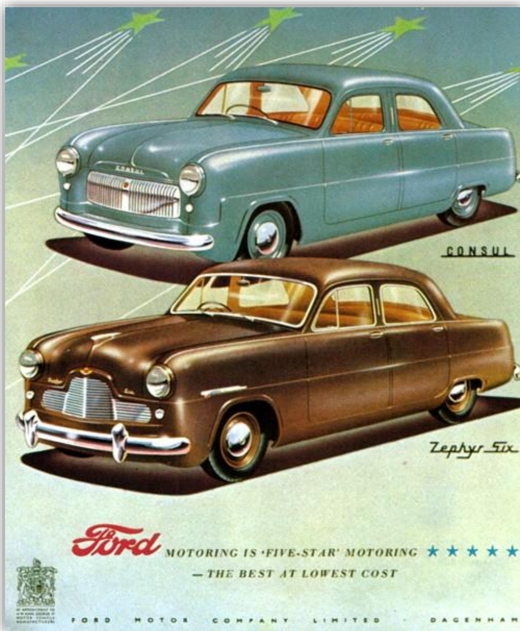
På Londonsalongen 1950 presenterade engelska Ford modellparet Consul och Zephyr-Six, de första bilarna med McPearson-framvagn. Zephyr hade en 2¼-liters sexa på 68 hk och ansågs vara en mycket snabb bil.
