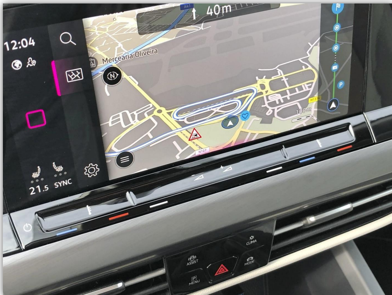
Ljudvolymen ändras på en tryckkänslig list under bildskärmen. Inte optimalt.
