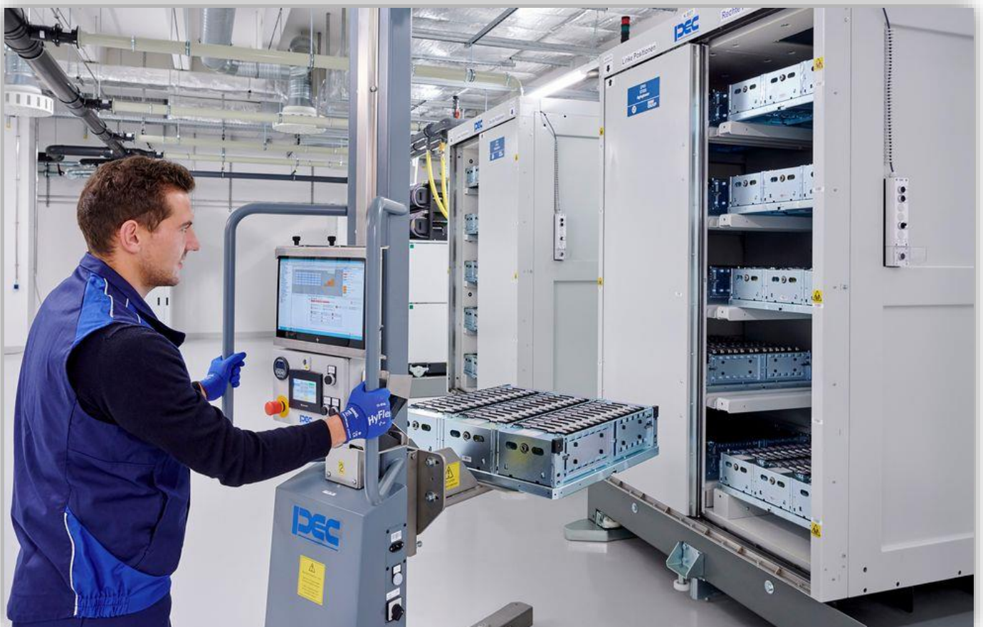
Test av batterier med NMC-celler på BMW:s nyabattericellkompetenscenter i München.
