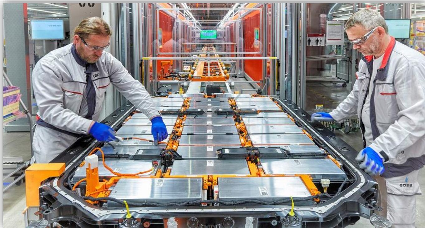
Montering av batteripaketet till Audi e-tron på fabriken i Bryssel. Notera de blanka lådorna, batterimodulerna, som är fyllda med battericeller.
