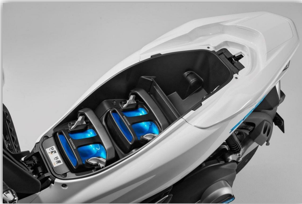
Hondas koncept PCX Electric med utbytbara batteripack.
