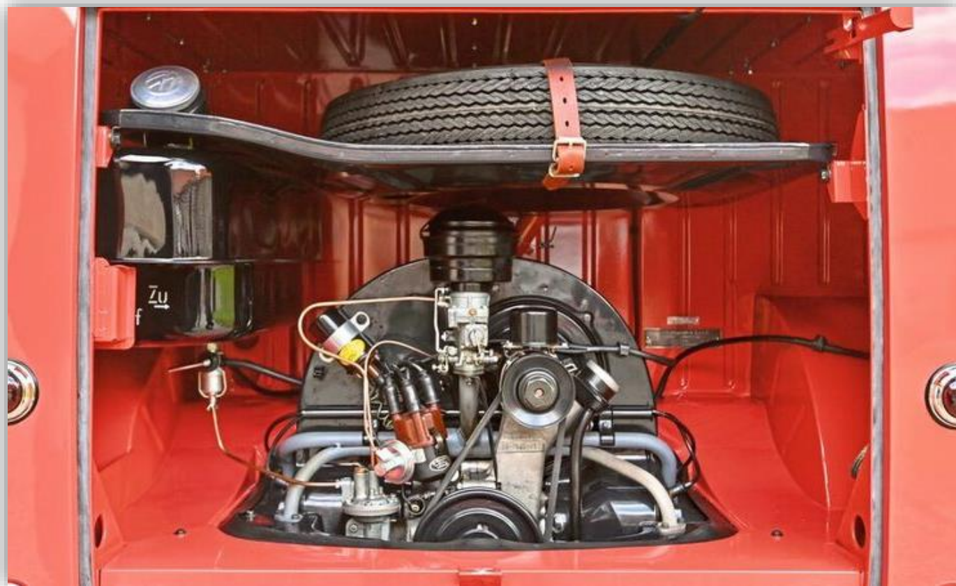
Blygsamma 25 hästkrafter i den luftkylda motorn.
