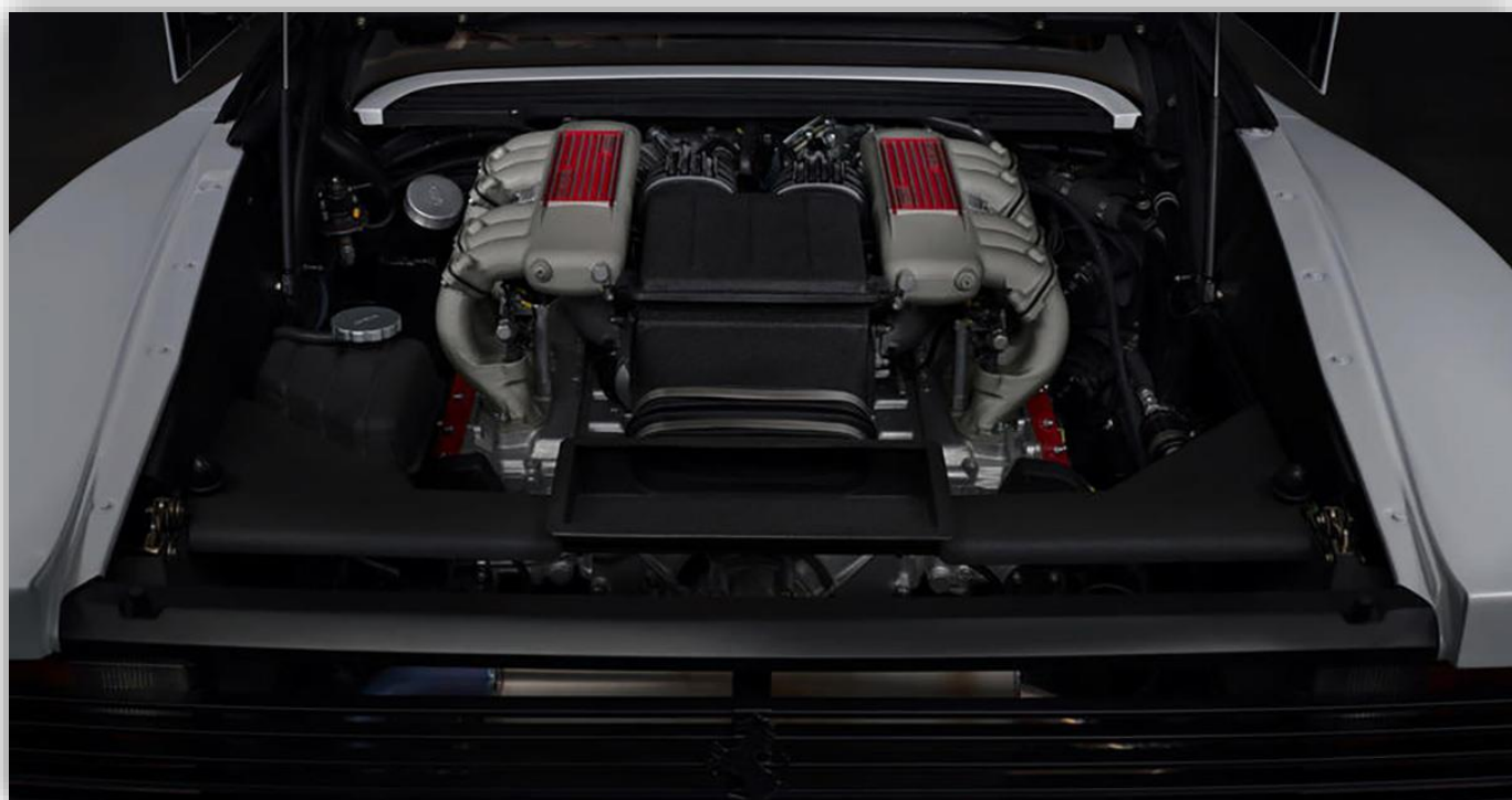
Den platta V12:an har 390 hästkrafter och en underbar motorsång i original. Den nya versionen får 510 hästkrafter.
