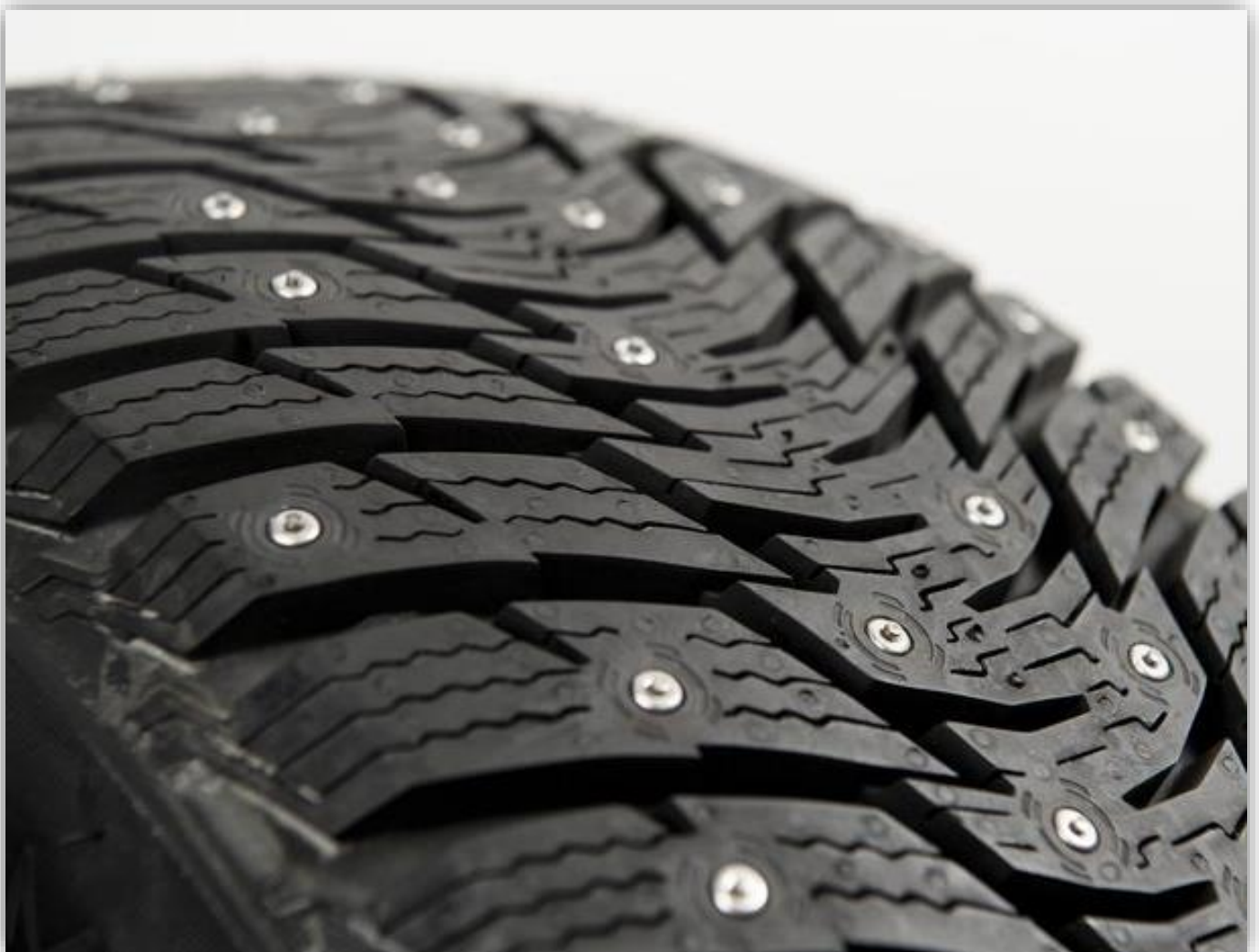
Goodride IceMaster Spike Z-506 har 200 dubbar som sticker ut alldeles för långt. Olagligt långt.
