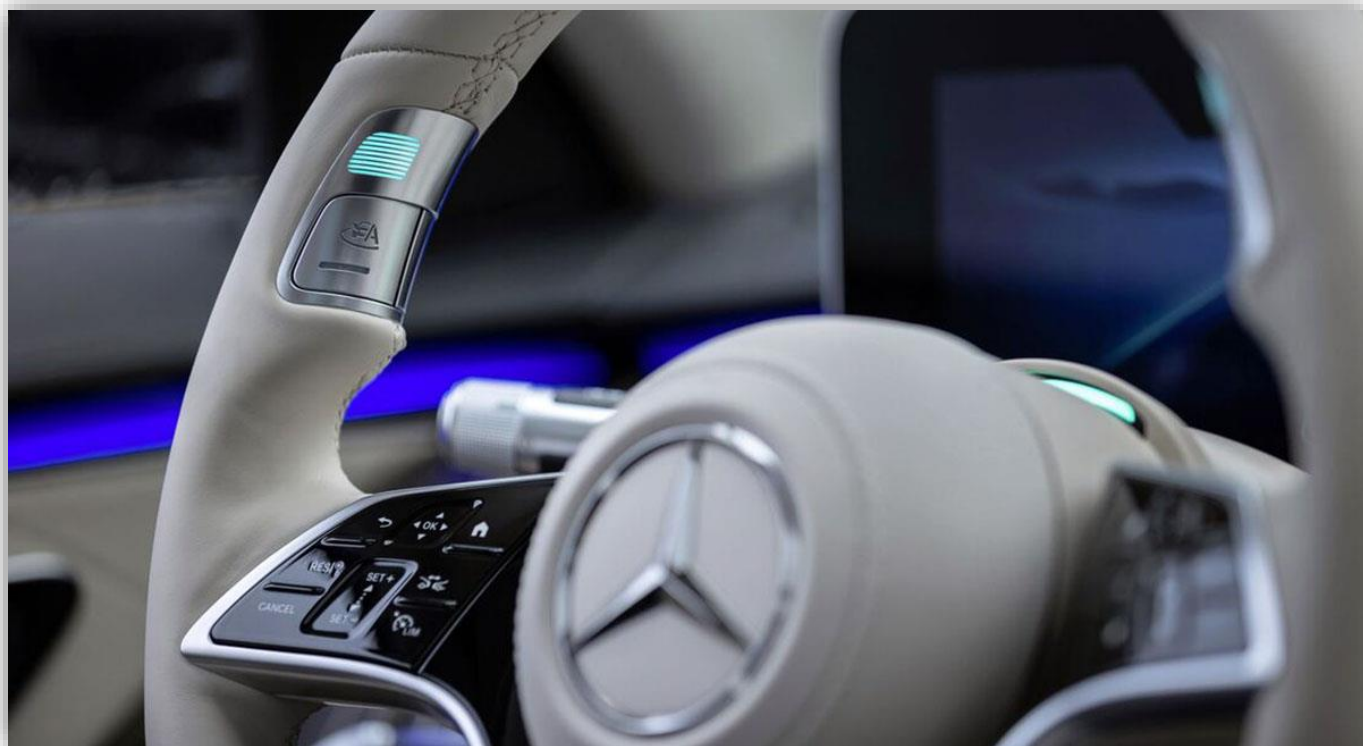
Systemet aktiveras med knappar på ratten.
