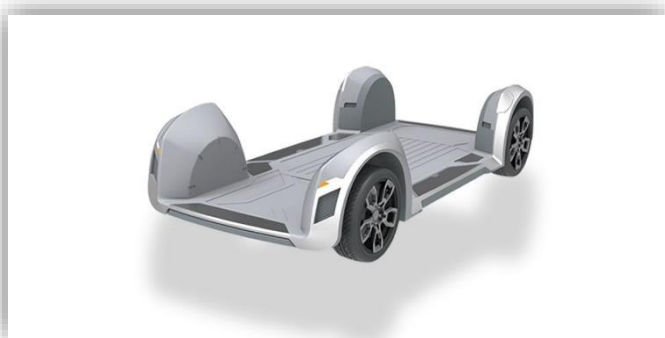
Ree Auto visar plattform för framtidens bilar. Där det mesta av det tekniska ryms i hjulhusen.
