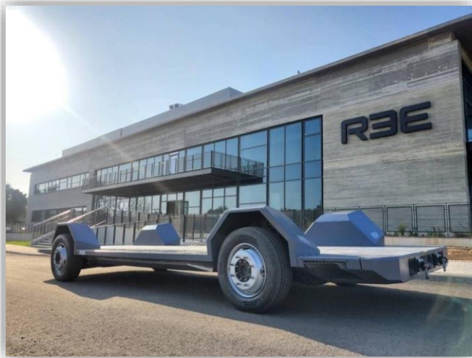
REE Automotive visar större elfordonsplattform. För bussar och lastbilar.
