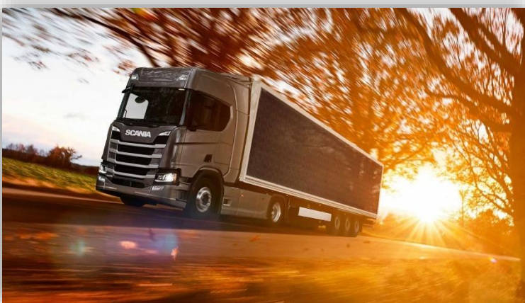
Scania testar släp med solceller på sig. Ska hjälpa till att få ner förbrukningen.
