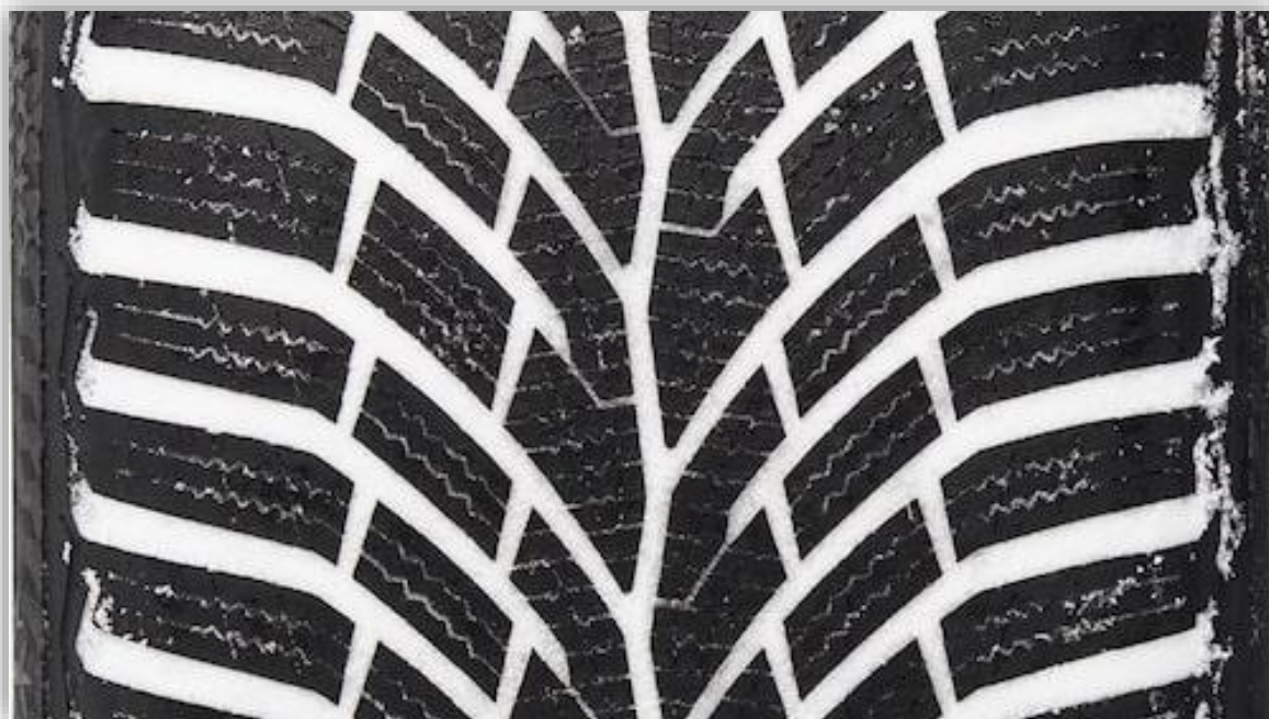
Ett mellaneuropeiskt dubbfritt däck (friktionsdäck). Benämndes förr som "centraleuropeiskt" däck.
