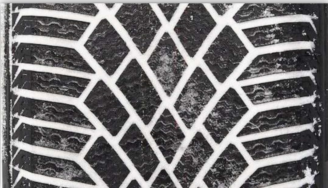
Ett nordiskt dubbfritt däck (friktionsdäck).
