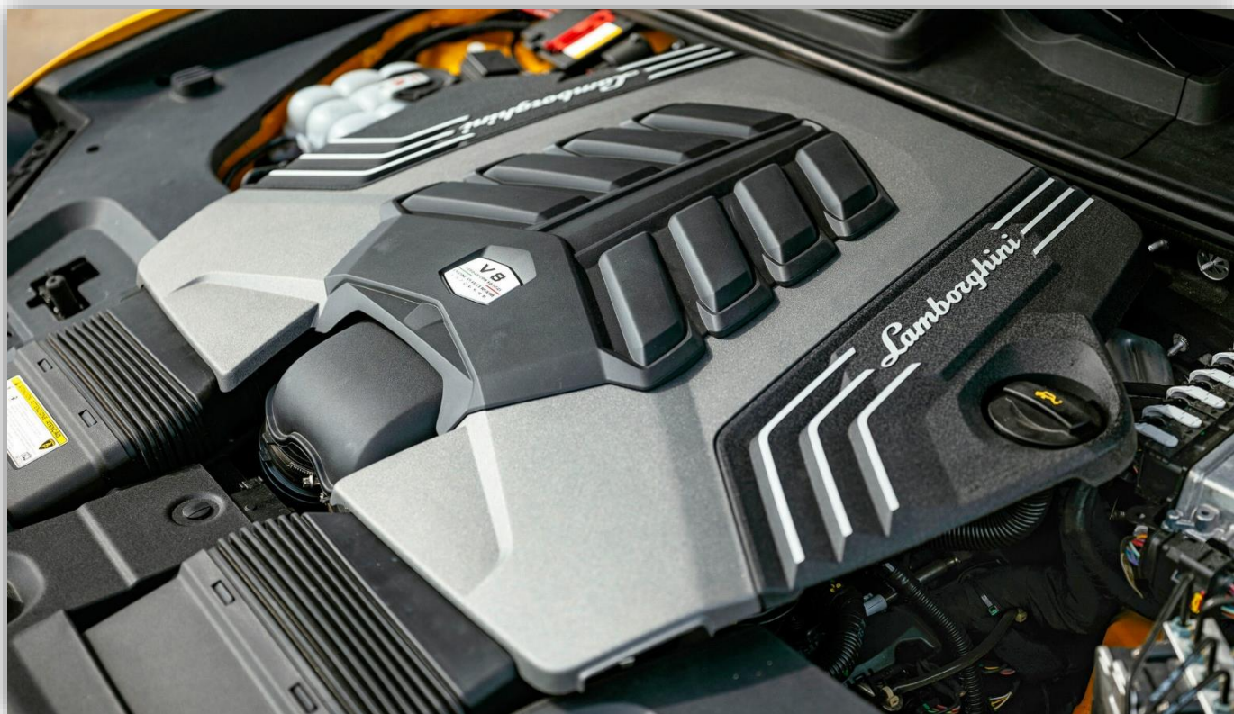
Bilens fyraliters V8 med dubbelturbo levererar kraft i massor.
