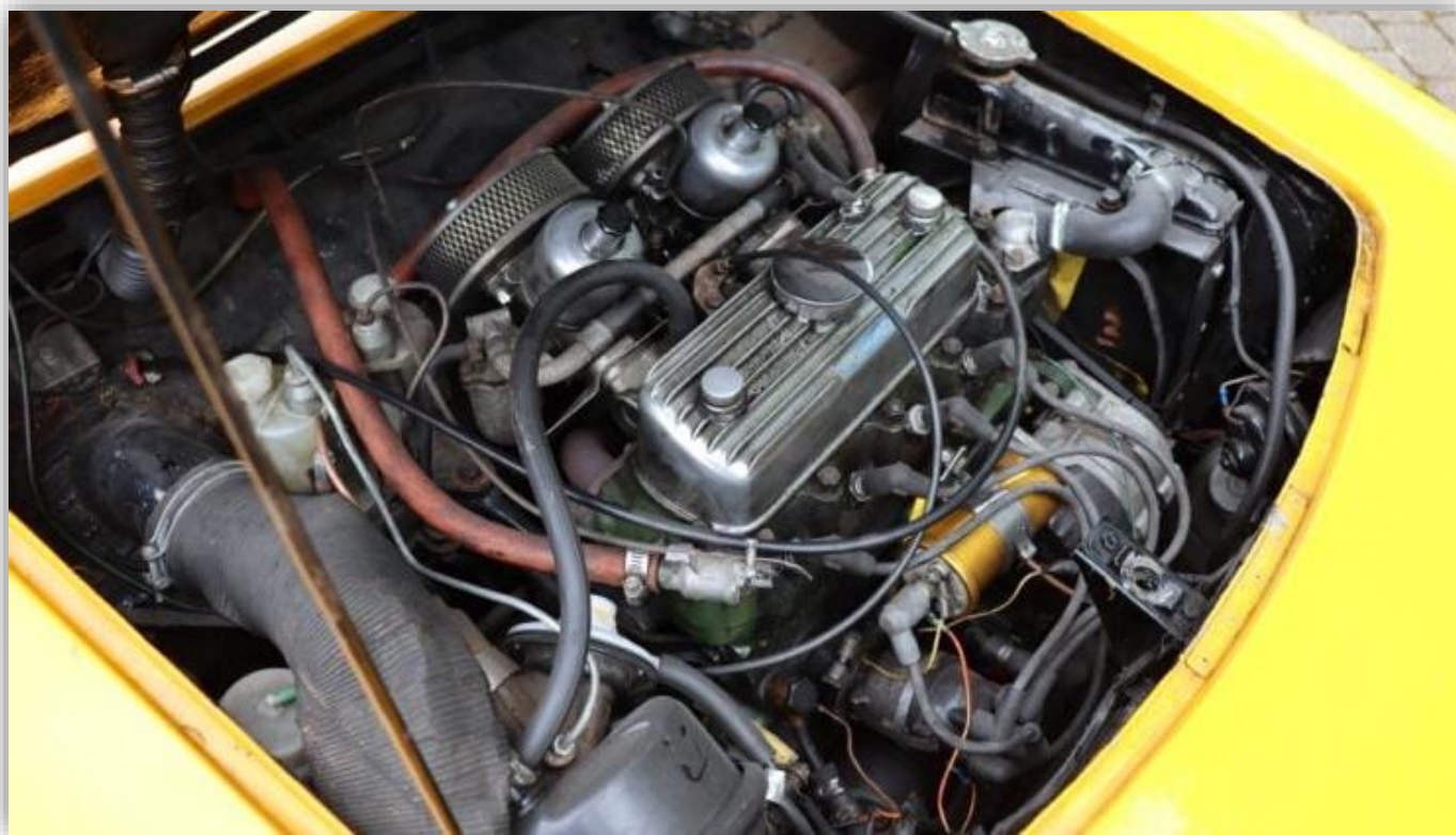
Kraften tillhandahålls av en utborrad 1275 Cooper S-motor med dubbla SU-förgasare och oljekylare.
