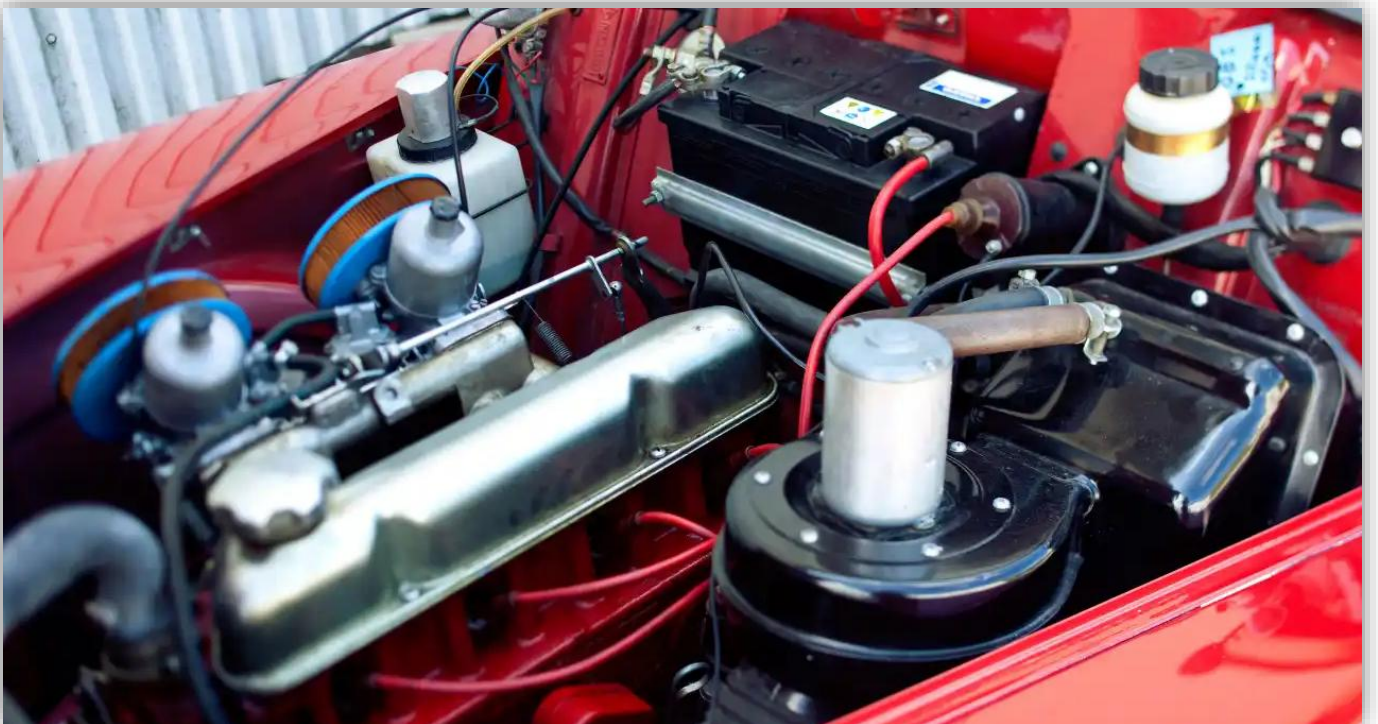
Dubbla SU-förgasare med öppnare filter. B18-motorn är strak och härlig – med rätta brum på toppvarv.
