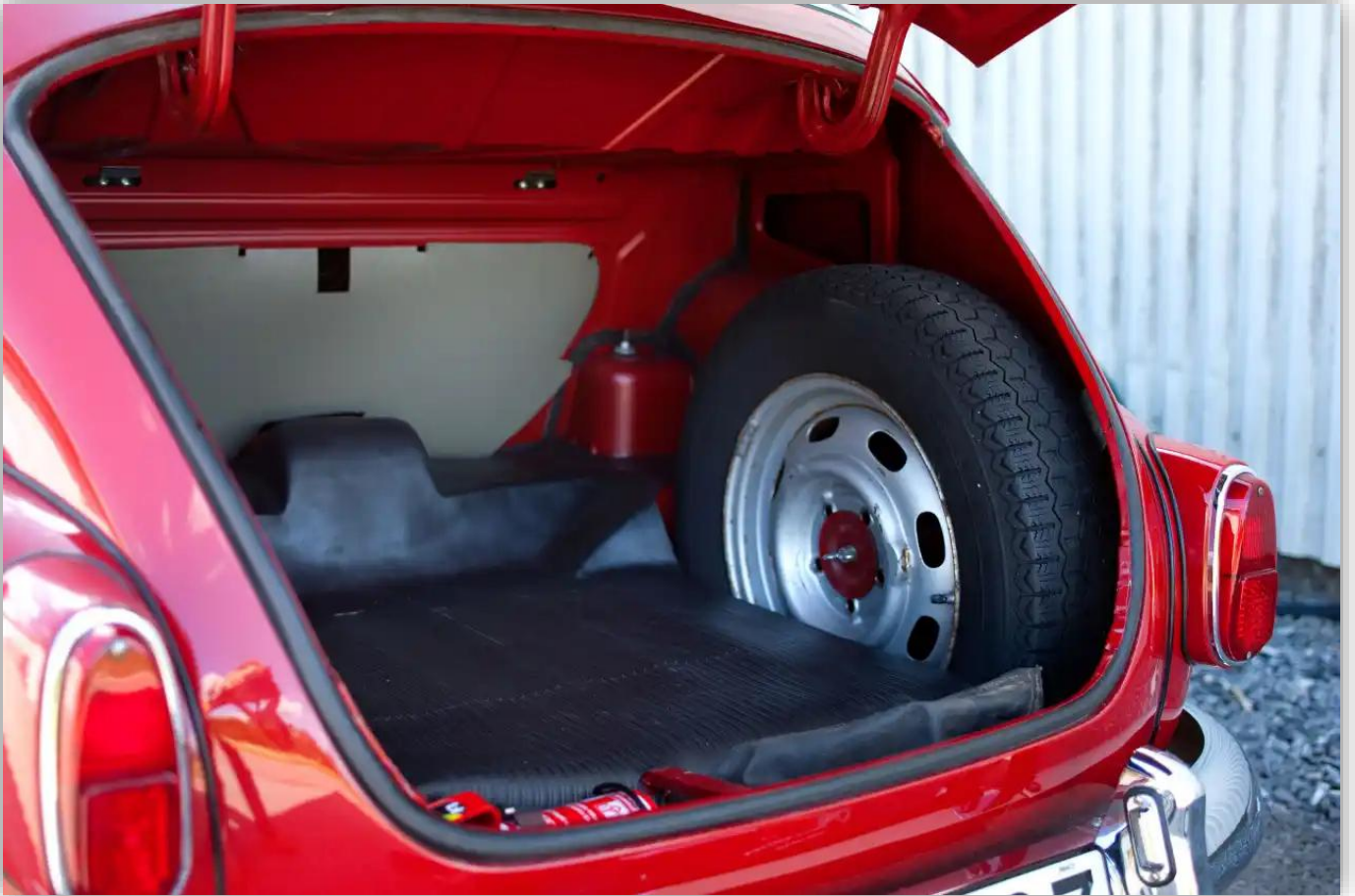
Stående reservhjul stjälar mindre plats än liggande. Den orepade gummimattan doftar härligt!
